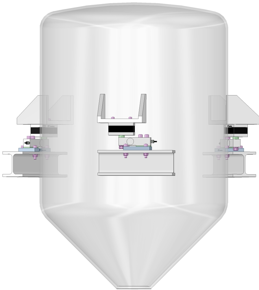
Silo a 3 punti di appoggio.
